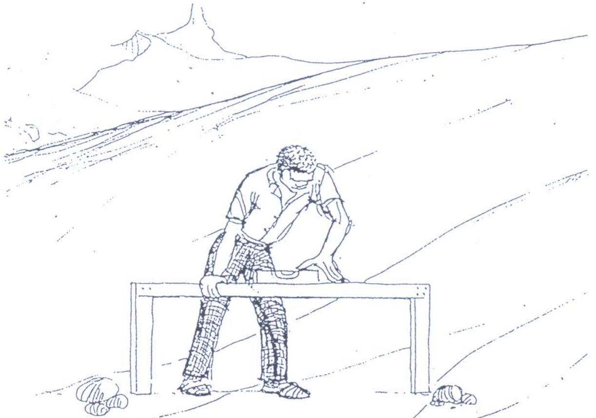
Piquetagem de Curva de Nível com cavalete e nível de bolha
