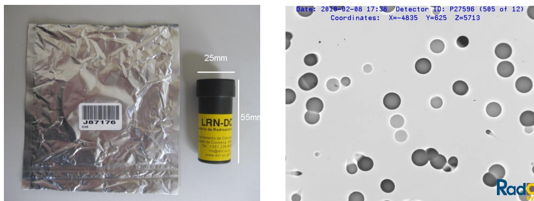
Figura 3.13 - Detector passivo do tipo CR39 em invólucro plástico anti-electrostático e respectiva embalagem de folha de alumínio (à esquerda), e aspecto dos impactos das partículas alfa no detector CR39 em observação ao microscópio após tratamento químico (à direita).
