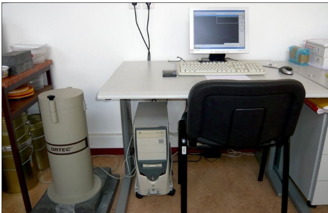
Figura 3.11 - Sistema de espectrometria gama Ortec com detector de 3x3" NaI(Tl) e castelo de chumbo para quantificação dos elementos radiogénicos, urânio, tório e potássio.
