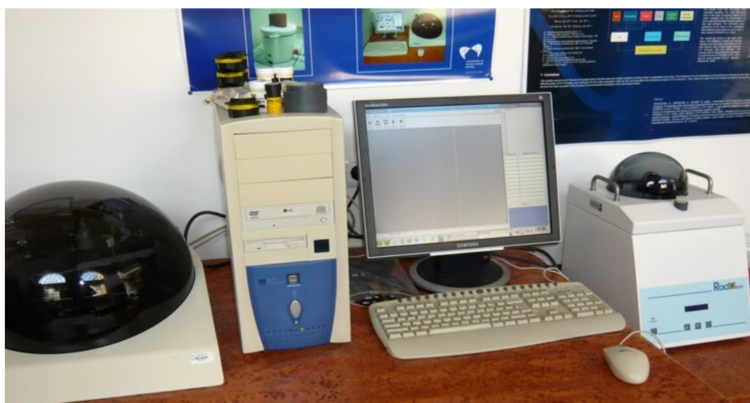
Figura 3.14 - Sistema de análise automática Radosys para contagem dos detectores passivos do radão do tipo CR39.
